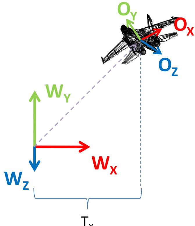
$$\begin{bmatrix} Proj_{W_x}(O_X) & Proj_{W_x}(O_Y) & Proj_{W_x}(O_Z) & T_X \\ Proj_{W_y}(O_X) & Proj_{W_y}(O_Y) & Proj_{W_y}(O_Z) & T_Y \\ Proj_{W_z}(O_X) & Proj_{W_z}(O_Y) & Proj_{W_z}(O_Z) & T_Z \\ 0 & 0 & 0 & 1 \end{bmatrix} \cdot \begin{bmatrix} V_X \\ V_Y \\ V_Z \\ 1 \end{bmatrix} = \begin{bmatrix} V'_X \\ V'_Y \\ V'_Z \\ 1 \end{bmatrix}$$
