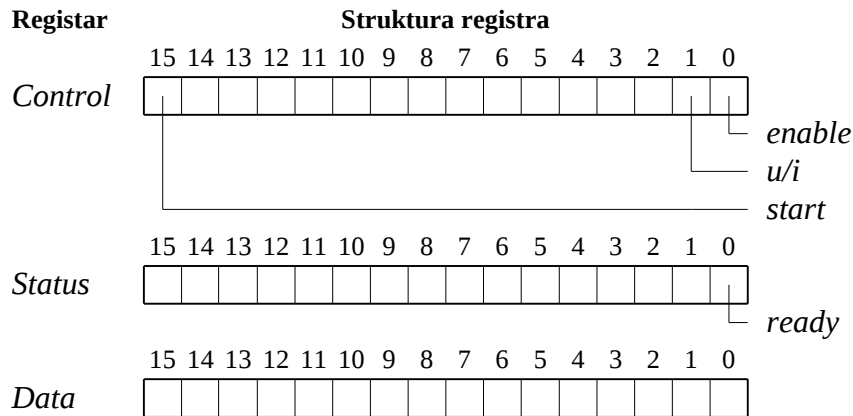
Слика 1 Адресе и структура регистра контролера периферија PER0 и PER1
